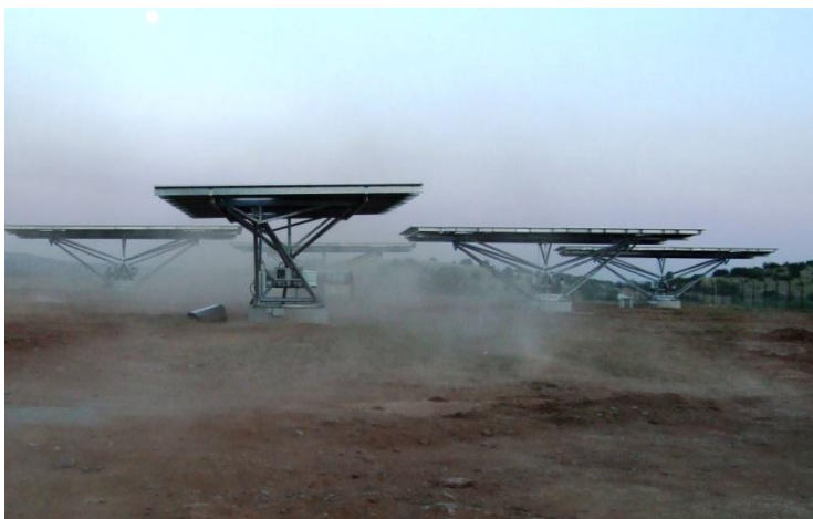
Εικόνα 20: Αυτόματη Οριζοντίωση στην περίπτωση Ισχυρών Ανέμων
