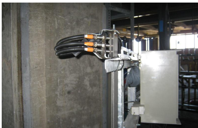
Εικόνα 42: Σύστημα ανίχνευσης θέσης
