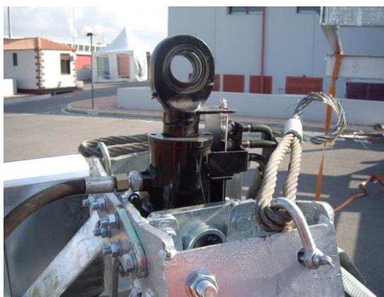
Εικόνα 19: Σημείο σύνδεσης Κινητού Πλαισίου στήριξης πάνω στη Βάση
